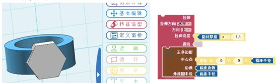
2.3 点击上面的拉伸积木块,右键单击选择复制,按照下图修改各参数值,其中"中心点" 坐标 Z 的值为 1.2 中建立的变量 Radius:
