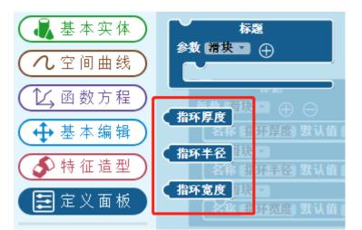
1.2 选择"变量" → "创建变量",在输入框中输入变量名字: Radius; 再选择"变量" → "赋值 Radius 为",设置 Radius 的值为:指环厚度+指环半径:
