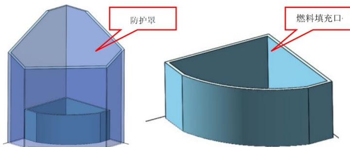
图 9 有防护罩的燃料填充口
